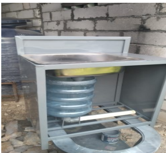
Gambar 3. Wadah Penampung Air Kotor yang Berisi Berbagai Partikel untuk Menyaring Air Kotor
